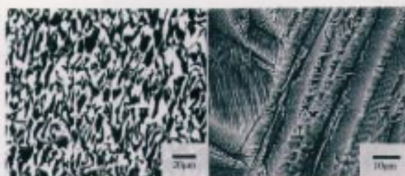
写真2 \text{Al}_2\text{O}_3\text{-Y}_2\text{O}_3 系の凝固組織。平衡共晶組織と準安定共晶組織
